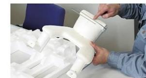
・芯材…発泡スチロールの中に針金の骨が入っているもの。針金と発泡スチロールを同時に成形する事で作られる。ひな人形、五月人形などに用いられる。
