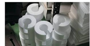
・カット品…ニクロム線で切断することで作られる。切断以外にも、穴あけや球体の加工など、主に簡易形状のもの加工を得意とする。
